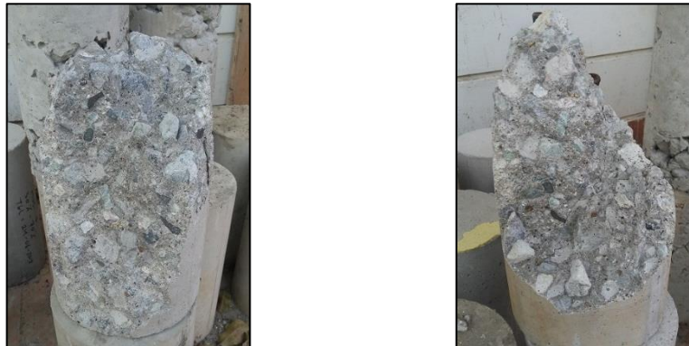
Gambar 4.2. Agregat kasar terlepas dari ikatan pada saat uji tekan di laboratorium
