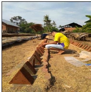
Gambar 2 Hasil Pembuatan Sampel Bata Segitiga
