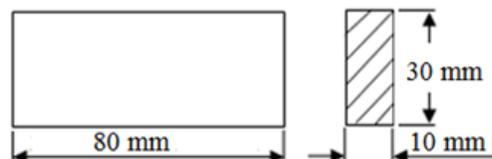
Gambar 4. Dimensi Spesimen Uji Kekerasan *Brinell*
