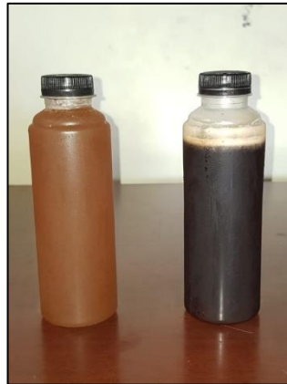
Gambar 7. Perbandingan fisik gula hasil vacuum evaporasi (kiri) gula cair hasil produksi manual (kanan)
