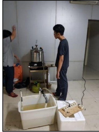
Gambar 5. Pendidihan nira cair pada panci vacuum evaporator di Lab Rekayasa EBT
