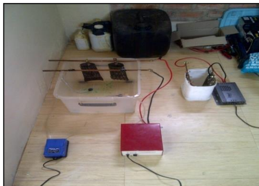
Gambar 3.4 Alat Elektroplating Nikel dan Chrome
